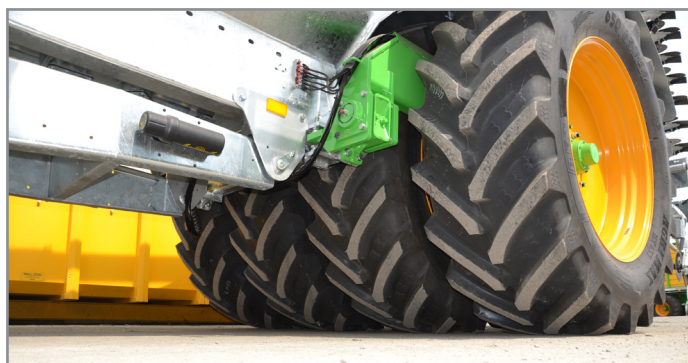
4 одинаковых параллельных колеса 650/85R38 (Ø 2.070 мм) позволяют равномерно распределить массу цистерны по поверхности.
